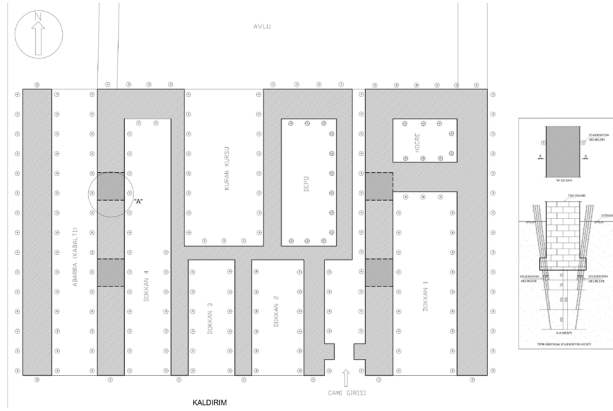
Şekil 3.3 : Melik Ahmet Paşa Cami, enjeksiyon plan ve detayı (VBM Arşivi).
